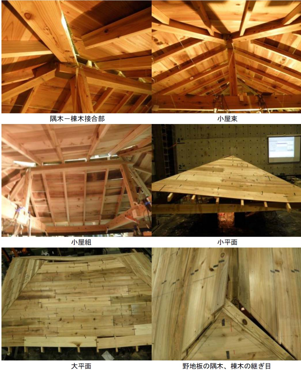
写真 2.2.3-1 伝統仕様寄棟試験体 (RHC) の破壊状況 (1/10rad 時)
