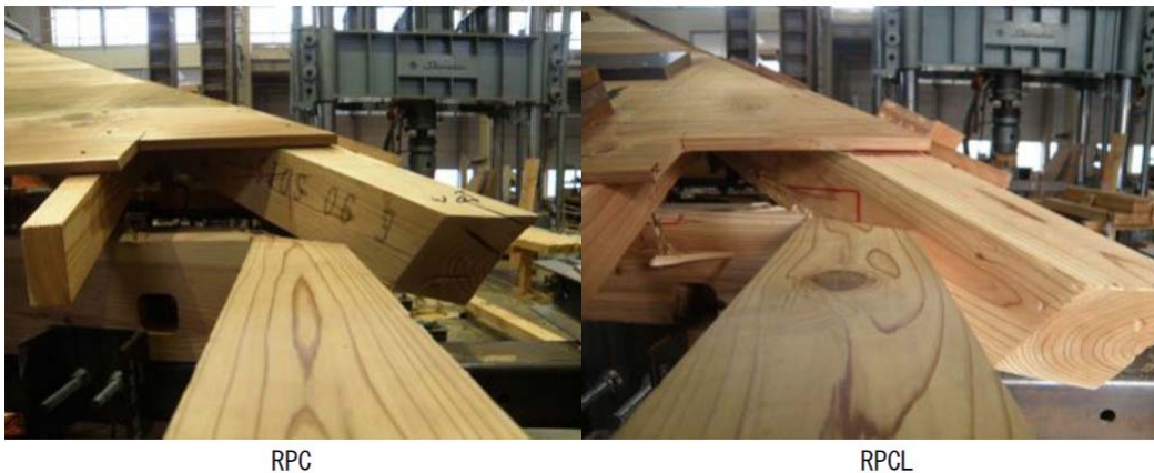
写真 2.2.4-1 伝統仕様方形試験体における隅木-桁接合部の状況
