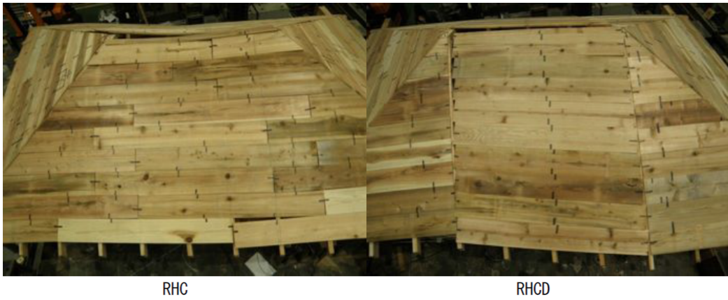
写真 2.2.3-2 伝統仕様寄棟試験体における野地板の割付の違いによる変形性状の比較
